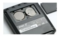
Verwenden Sie für den Wechsel keine metallischen Gegenstände, um einen Kurzschluss der Batterien zu vermeiden.
